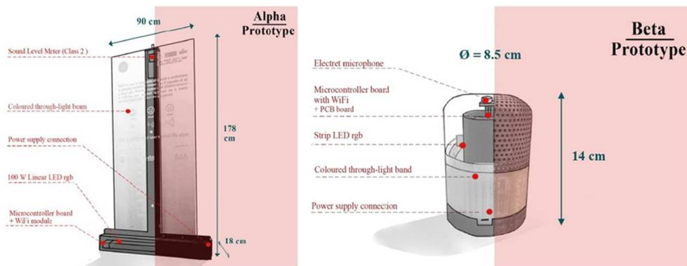
Figure 1 - Diagrammatic representation of Alpha and Beta prototypes, their hardware components and physical dimensions. – Rappresentazione schematica del prototipo Alpha e Beta con indicazione delle componenti hardware e delle dimensioni.
