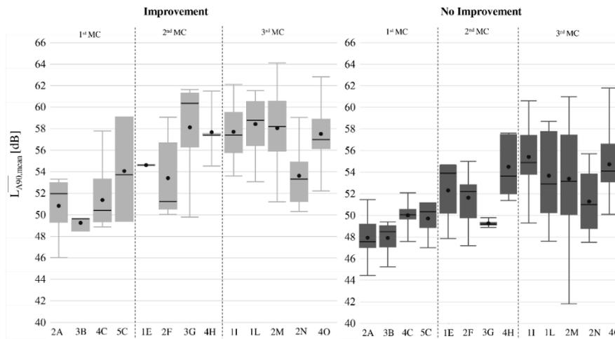
Figure 3 - Boxplots on the distribution of  $L_{A90,mean}$  values for each class related to P1 split into “improvement” and “no improvement” groups. The thick line across the box and the dot indicates the median and mean, respectively. – I box plot rappresentati la distribuzione dei dati di  $L_{A90,medio}$  relativi alla fase P1 per ogni classe e per i due gruppi: “miglioramenti” e “non miglioramenti”. La linea centrale indica la mediana e il punto il valore medio.
