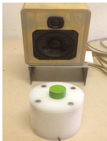
Figura 16 - Configurazione sperimentale per la caratterizzazione acustica del metamateriale (risonatore+filtro acustico) - Experimental configuration for the acoustic characterization of the metamaterial (resonator + acoustic filter).
