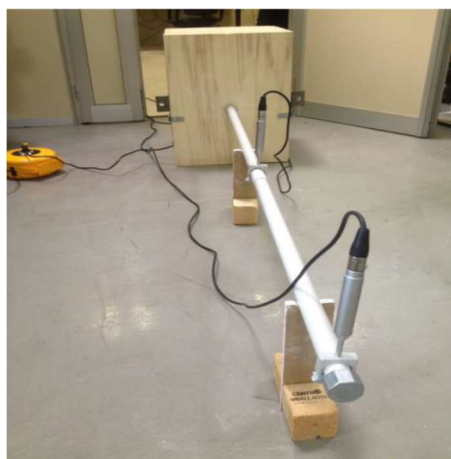
Figura 11 - Set-up sperimentale per la misura della resistività al flusso in tubo di impedenza - Experimental set-up for the flow resistivity measurement in impedance tube.
