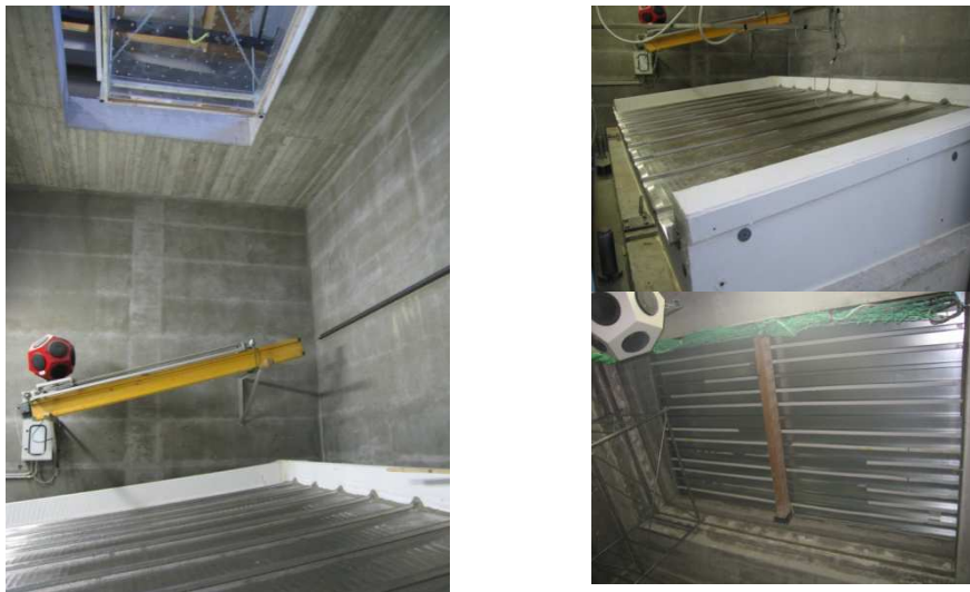
Figura 2 - A sinistra, gli ambienti di prova; a destra il campione del test n. 10 visto dalla camera emittente e da quella ricevente - On the left, the test environment; on the right the n. 11 test sample viewed from the source room and from the receiving one.
