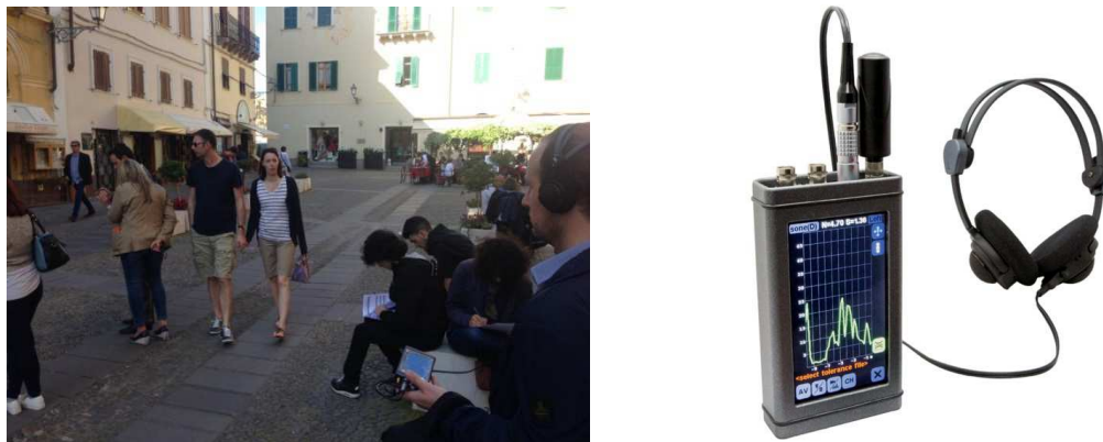
Figura 4 - Strumentazione impiegata per le registrazioni binaurali, (a destra) lo SQobold-Head Acoustics - Instrumentation used for the binaural recordings, (on the right side) SQobold-Head Acoustics.
