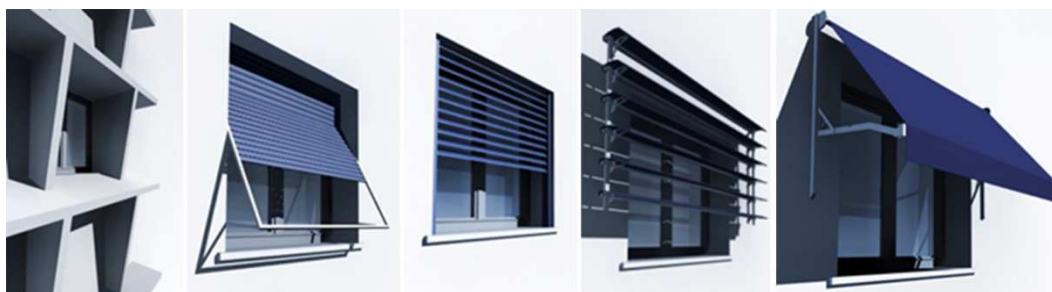
Figura 1 - Esempi di tipologie di sistemi di facciata per la schermatura della radiazione solare - Examples of devices for shading from solar radiation.
