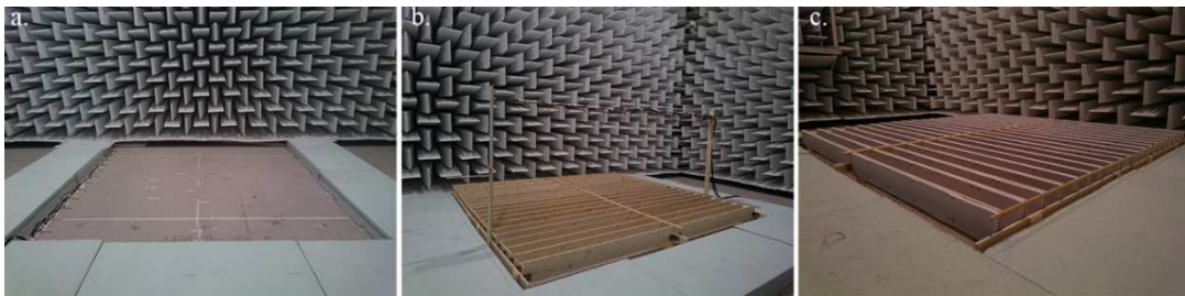
Figura 3 - Modello appoggiato sul pavimento della camera semi-anecoica. In primo piano la protezione del perimetro in fibra di poliestere. A) pavimento della camera semi-anecoica, corrispondente alla facciata non schermata; b) Modello di sistema frangisole non modificato; c) Modello del sistema frangisole fonoassorbente. - Model lying on the floor of the semi-anechoic chamber with the polyester fiber to protect the perimeter from unwanted reflections: a) Blank floor of the semi-anechoic chamber; b) Model of the standard shading device; c) Model of the sound absorbing shading device.
