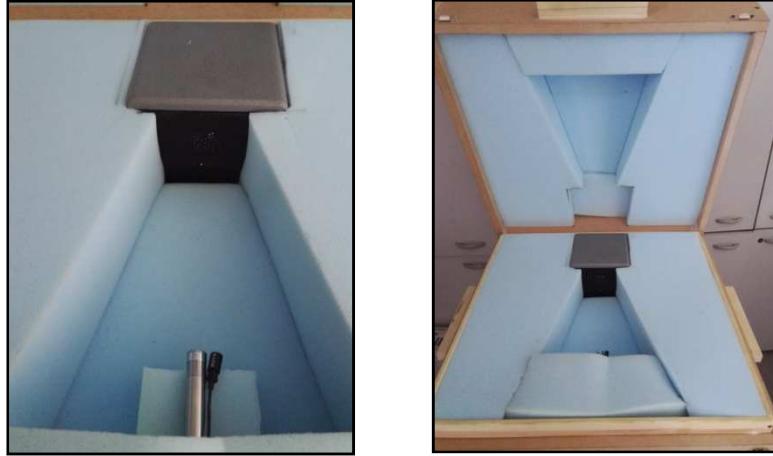
Figura 2 – Scatola per simulare una camera anecoica - Box to simulate an anechoic room.
